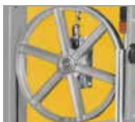
Diametro volani 354 mm ed indicatore di tensione lama Diamètre des volants 354 mm et indicateur de tension de la lame
