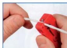
Usare la lama frontale (venduta separatamente). Può essere utilizzata per fare un taglio longitudinale per rimuovere lunghi spezzoni di isolante. Inserire il cavo nell'incavo
