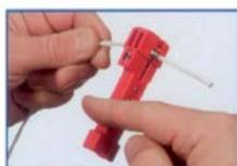
Ruotare l'utensile verso il basso e lontano dall'operatore. Solo due o tre rivoluzioni dell'utensile sono normalmente necessarie per incidere l'isolante.
