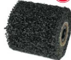
Con foro d'attacco Ø mm 19,1 e sede per chiavetta. Adatte per le più diffuse smerigliatrici, lucidatrici e satinatrici. In gomma abrasiva per satinare acciai inossidabili. Dimensioni mm 100x100. Velocità massima 1910 giri/min.
