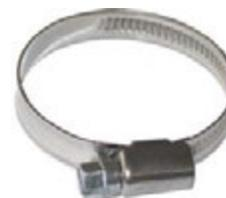
Tipo DIN 3017 con nastro e cassetto in acciaio INOX 430, W 2, vite zincata a forte resistenza all'ossidazione. Nastro imbutito, bordi arrotondati e rialzati. Vite con esagono mm 7.
