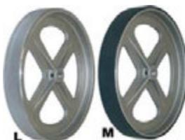
In duralluminio. Con vite di fissaggio. Circonferenza mm 500, diametro mm 160, larghezza fascia mm 23, diametro foro attacco mm 8. Da applicare ai contametri Art. 4449 GD-S e 4451 GD-S. Con superficie zigrinata.
