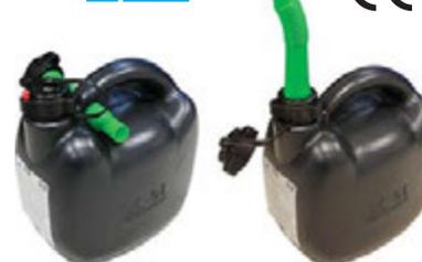
Tipo professionale in POLIETILENE RINFORZATO AD ALTA DENSITA' (HDPE), infrangibile, conforme alle direttive UN 96/49/CE, adatte anche per il trasporto di liquidi infiammabili via terra (strade e ferrovia), via mare e via aerea.
