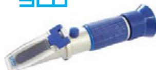
Tipo analogico professionale per il controllo e la misurazione della concentrazione dell'UREA. Con sistema automatico di compensazione della temperatura ambientale.
