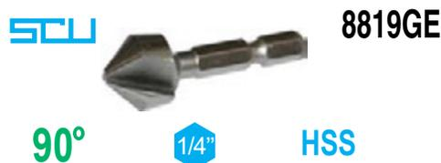
Tipo a 3 taglienti, rettificati. Per svasare fori nel ferro, acciaio, leghe leggere e leghe non ferrose. CONICITA' TESTA a 90°. In acciaio SUPER-RAPIDO HSS con rivestimento TIN. Attacco esagonale 1/4. Indicate per uso con avvitatori elettrici e a batteria.
