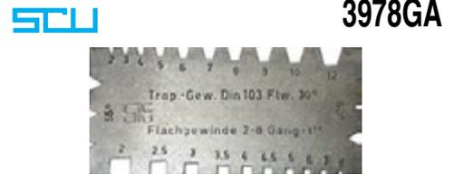
Tipo per filetti Whitworth, metrici, trapezoidali da mm 2 a mm 12 e con intagli da 40° a 80° per utensili da taglio. Con un'asta registrabile per stabilire e controllare angoli da 0° a 30°. Spessore mm 2.
