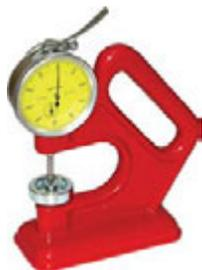
Divisione 1/100 mm, con levetta sensitiva e ritorno automatico. Particolarmente adatti per misurare spessori di pastiglie punterie di motori. Tipo con base d'appoggio e contatti a forma piana (inf.) e sferica (sup.).
