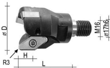
Tipo per SPALLAMENTI con attacco filettato e refrigerazione interna.
