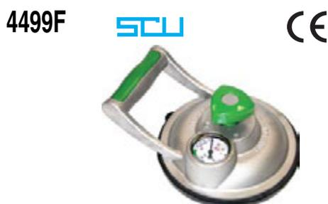
Adatte per trasportare lastre con superfici lisce come il vetro, plastica, metalli ecc. Costruzione in fusione d'alluminio. Con vuotometro per il riscontro della pressione di presa. Con manopola centrale per la regolazione del vuoto.
