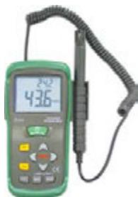
Tipo professionale combinato per il rilevamento dell'umidità relativa dell'aria (%) e la misurazione della temperatura in gradi centigradi (°C) o gradi Fahrenheit (°F).
