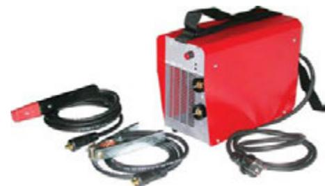
Saldatrici, professionali, elettriche in corrente alternata monofase costruite secondo le norme EN 60974-1/EN 60974-10. Raffreddamento forzato ad aria per uso continuo. Regolazione elettronica continua della corrente mediante manopola con scala graduata. Protezione automatica contro il surriscaldamento con riavvio automatico.
