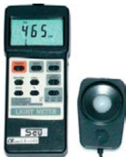
Tipo elettronico digitale, per rilevare l'intensità luminosa della luce (solare, al tungsteno, fluorescente, al mercurio, ecc.).
