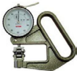
Tipo professionale, con CONTATTI A RULLI E GUIDE, larghezza mm 8,7 e diametro mm 8,4. Apertura utile mm 5. Profondità arco mm 50. Particolarmente adatti per misurare spessori di cavi, fili, nastri, ecc. Divisione 1/100 mm, con levetta sensitiva e ritorno automatico. Grande quadrante di facile lettura con 2 lancette indicanti: millimetri, i decimi e centesimi di millimetro.
