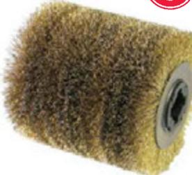
Con foro d'attacco Ø mm 19,1 e sede per chiavetta. Adatte per le più diffuse smerigliatrici, lucidatrici e satinatrici. In filo di resistente nylon, ricoperto di graniglia abrasiva. Per sbavare e pulire superfici non metalliche e metalliche. Dimensioni mm 100x100. Velocità massima 6800 giri/min.
