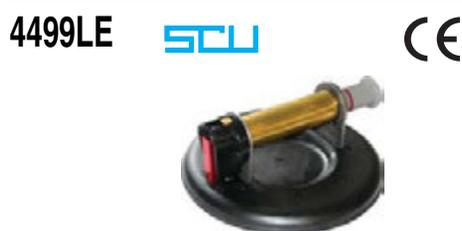
Adatte per trasportare lastre con superfici non solo lisce e piane, ma anche lievemente lavorate e curve. Robustissima costruzione rivestita in gomma, corpo pompa in ottone e pistone in materiale sintetico. Il vuoto è ottenuto mediante l'azionamento della pompa manuale e può essere controllato sul pistone grazie ad un indicatore di colore rosso.
