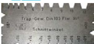
Tipo per filetti Whitworth, Metrici, trapezoidali da mm 2 a mm 12 e con intagli da 40° a 80° per utensili da taglio.
