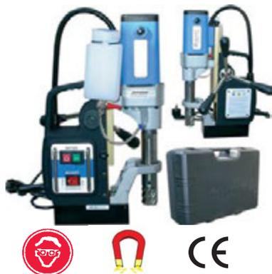
Costruzione robusta, compatta, leggera, con supporto magnetico che permette l'impiego verticale, orizzontale o capovolto. Motore monofase 230 V-50 Hz con interruttore di sicurezza di sovraccarico incorporato. Munito di dispositivo contro l'avviamento involontario del trapano prima che sia inserito il magnete. Lubrificazione automatica. Attacco Weldon Ø mm 19. In pratica valigetta di trasporto.
