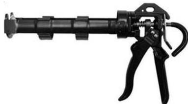
Tipo Industriale molto robusto ad elevata forza di spinta. Frizione e asta di spinta temprate a compensazione di usura (W.D.C). Movimento a frizione con guscio portacartuccia rinforzato, rotante e clip di bloccaggio della cartuccia. Ampia e confortevole leva di azionamento a movimento dolce e progressivo. Per cartucce da ml 280/300.
