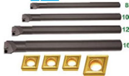
In acciaio trattato. Sistema di fissaggio mediante disco con vite filettata, adatti per tornire e copiare.
