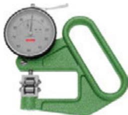
Tipo professionale, con CONTATTI A RULLI, larghezza mm 8,7 e diametro mm 8,4. Apertura utile mm 5. Profondità arco mm 50. Particolarmente adatti per misurare spessori di cavi, fili, nastri, ecc. Divisione 1/100 mm, con levetta sensitiva e ritorno automatico. Grande quadrante di facile lettura con 2 lancette indicanti: millimetri, i decimi e centesimi di millimetro.
