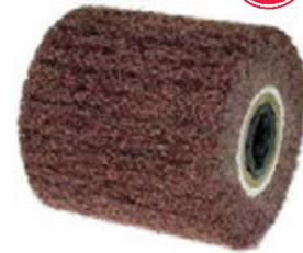
Con foro d'attacco Ø mm 19,1 e sede per chiavetta. Adatte per le più diffuse smerigliatrici, lucidatrici e satinatrici. In tessuto-non tessuto ad alta impregnazione. Abrasivo al carburo di silicio, per ottenere puliture di ruggini, sbavature di saldature, sverniciature di metalli, legni, intonaci, cemento. Non danneggia e non surriscalda la superficie da lavorare. Dimensioni mm 100x100. Velocità massima 6800 giri/min.
