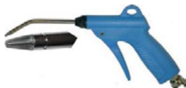
Tipo Industriale con progressività di erogazione dell'aria mediante pressione sulla leva. Corpo in speciale resina indeformabile, parti interne in ottone. Attacco rapido unificato. Con canna piegata, lunghezza mm 125, smontabile, ugello di sicurezza con silenziatore incorporato.
