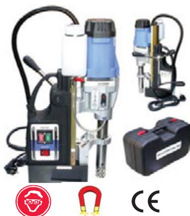
Costruzione robusta, compatta, stabile, con supporto magnetico che permette l'impiego verticale, orizzontale o capovolto. Motore monofase 230 V-50 Hz con interruttore di sicurezza di sovraccarico incorporato. Munito di dispositivo contro l'avviamento involontario del trapano prima che sia inserito il magnete. Lubrificazione automatica. Attacco Weldon Ø mm 19. In pratica valigetta di trasporto.
