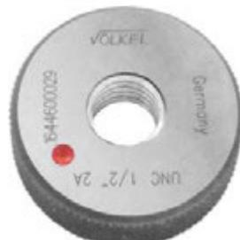
Calibro ad anello di ALTA PRECISIONE, NON PASSA per filettatura americana UNC destra secondo le norme ANSI B 1.1. Tolleranza 2A, in acciaio speciale temprato.
