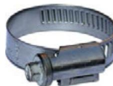
Tipo DIN 3017, completamente in acciaio INOX 316, W 5. Nastro imbutito, bordi arrotondati e rialzati. Vite con esagono mm 7.
