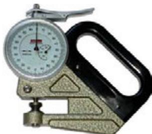
Tipo professionale, di altissima precisione. Divisione 1/1000 mm. Particolarmente adatti per misurare fogli di spessore estremamente sottili. Impugnatura isolata per evitare l'influenza del calore della mano. Forza di pressione controllata di c.ca 2 Nm. Profondità arco mm 30. Apertura utile mm 1 (ogni giro della lancetta corrisponde a mm 0,2). Contatti tondi piani Ø mm 6,3.
