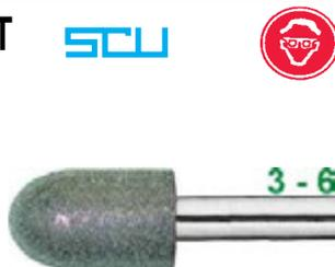
Tipi speciali con superficie diamantata a lunga durata ed elevato rendimento. Particolarmente indicati per la lavorazione di Metallo Duro, acciai temprati, vetri, ceramiche, ecc. Velocità di rotazione fino a 20 m/sec. Grana media (D126).
