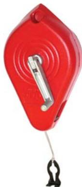
Tipo professionale, con corpo in lega di magnesio, resistente e leggero e filo in cotone/nylon per la massima capacità di impregnazione della polvere/robustezza, lunghezza m 30. Sistema veloce d'estrazione della corda, senza rotazione della manovella, mediante pressione sul tasto "PUSH". Gancio di ancoraggio temprato e dentato, con sede nel corpo del tracciatore per un comodo e sicuro alloggiamento.
