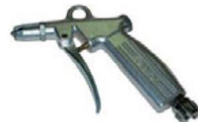
Tipo Industriale con erogazione progressiva dell'aria mediante pressione sulla leva. Corpo in alluminio forgiato. Getto potente con minimo consumo. Attacco rapido unificato. Con canna piegata, lunghezza mm 125, smontabile, ugello di sicurezza con silenziatore incorporato.
