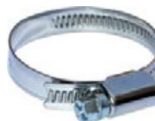
Tipo DIN 3017, completamente in acciaio INOX 304, W 4. Nastro imbutito, bordi arrotondati e rialzati. Vite con esagono mm 7.
