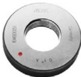
Calibro ad anello di ALTA PRECISIONE, NON PASSA per filettatura GAS cilindrica destra secondo le norme DIN ISO 228. Tolleranza A, in acciaio speciale temprato.
