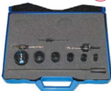
Tipo con denti rivestiti di grani in metallo duro, professionale. Da usare su trapani portatili e a colonna. Permettono tagli aggressivi ma uniformi, veloci e leggeri. Lunga durata del dente e della affilatura. Per forare tutti i tipi di materiali abrasivi e duri come fibre di vetro, carbonio, kevlar, grafite, cementi, marmi, graniti, ceramiche, ghise ecc. Profondità utile di taglio mm 40.
