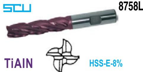
Tipo a taglienti elicoidali ed elica sinusoidale. Di elevatissimo rendimento, permette una riduzione delle vibrazioni, una maggiore evacuazione del truciolo, minor potenza assorbita, riduzione del livello sonoro, eccellente grado di finitura della superficie lavorata, maggiore durata, velocità ed avanzamenti superiori. Serie lunga. Attacco Cono Morse e foro filettato. Tolleranza tagli. J14. Ø mm 16 e 20 = 4 tagli./Ø mm 25 = 5 tagli./Ø mm 30 a 40 = 6 tagli.
