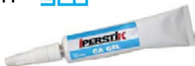
Adesivi istantanei universali a base di cianoacrilato di etile. GEL, ad alta viscosità, che permette di riempire eventuali spazi senza colare e per applicazioni verticali. Adatti per incollare acciai, gomma, materie plastiche anche su superfici metalliche.
