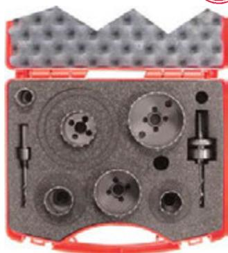
Tipo con denti riportati in metallo duro, professionale. Denti stradati a dentatura fissa, 3 denti per pollice. Da usare su trapani portatili o a colonna. Grande resistenza all'abrasione e lunga durata del dente e della affilatura. Per forare fibre di vetro al carbonio, grafite, acciai duri, leghe al Titanio, ghise ecc. Profondità utile di taglio mm 40.
