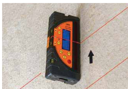
Fig. 5 - Ricevitore FR 77MM con funzione TRACKING e misura in mm in modalità orizzontale
