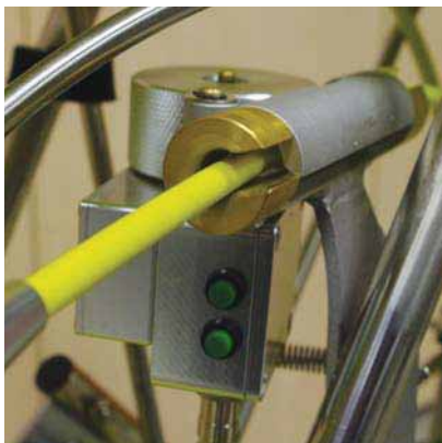
Misuratore della sonda per determinare la corretta posizione della testa
