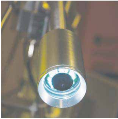
Testa videocamera autolivellante diametro 50mm
