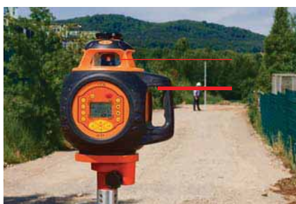
Fig. 4 - Funzione TRACKING per pendenze e raccordi
