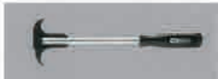
Utensili per la ribattitura dei rivetti
