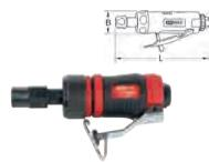
Dati tecnici: Mandrino di serraggio: 6 mm Potenza: 230 Watt Velocità a vuoto 25000 giri/min Vibrazione < 1.5 ms<sup>2</sup> Livello di potenza sonora 95 dhA Livello di pressione acustica 81 dbA Consumo aria: 319.93 l/min Diametro min. del tubo dell'aria: 1/4" - 6.4 mm Pressione di esercizio: max. 5,5 bar (80 psi)
