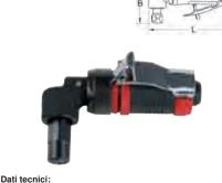
Mandrino di serraggio: 6 mm 190 Watt Potenza: 19000 giri/min Velocità a vuoto: < 1.5 ms<sup>2</sup> Vibrazione: Livello di potenza sonora 95 dbA Livello di pressione acustica 82 dbA Consumo aria: 240.66 l/min. Diametro min. del tubo dell'aria: 1/4" - 4.8 mm Pressione di esercizio: max. 5,5 bar (80 psi) Attacco fil ttato: 1/4"
