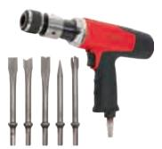
Dati tecnici: Attacco scalpello: Numero di percussioni: 2900 colpi/min 5,35 ms<sup>2</sup> 104,9 dbA Livello di potenza sonora Livello di pressione acustica 90,4 dbA 77,3 l/min. Consumo aria: Pressione di esercizio max. 6,3 bar (90 psi) Attacco fil ttato: 1/4"PT
