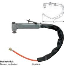
Numero oscillazioni: Velocità a vuoto: 22000 giri/min. Vibrazione: 4.3 m/s<sup>3</sup> Livello di potenza sonora 79.8 dbA Livello di pressione acustica 69,9 dbA Consumo aria: 300 l/min. Pressione di esercizio: 6.3 bar (90 psi) Diametro min. del tubo dell'aria: 3/8" - 10 mm Attacco fil ttato: 1/4"PT
