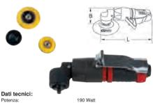
Velocità a vuoto: 4000 airi/min Diametro spugna: 50 + 75 mm Diametro del disco in velcro: 46 mm Vibrazione: 1.5 ms<sup>2</sup> Livello di potenza sonora 95 dbA 81 dbA Livello di pressione acustica Consumo aria: 240.66 l/min. Diametro min. del tubo dell'aria: 1/4" - 4.8 mm max. 5.5 bar (80 psi) Pressione di esercizio: Attacco fil ttato: 1/4"
