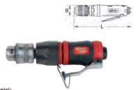
Dati tecnici: 1 - 6,5 mm Filettatura attacco mandrino: 3/8" x 24 UNF 190 Watt Potenza: Velocità a vuoto 6000 giri/min < 0,7 ms<sup>2</sup> Vibrazione: Livello di potenza sonora 95 dbA Livello di pressione acustica 80 dbA 240.66 l/min. Consumo aria: Diametro min. del tubo dell'aria: 1/4" - 4.8 mm max. 5,5 bar (80 psi) Pressione di esercizio: 1/4"NPT
