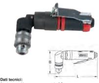
1 - 6,5 Filettatura attacco mandrino: 3/8" x 24 UNF Potenza: 230 Watt Velocità a vuoto: 4500 giri/min < 0,7 ms<sup>2</sup> Vibrazione: Livello di potenza sonora 95 dbA 83 dbA Livello di pressione acustica 240.66 l/min. Consumo aria: Diametro min, del tubo dell'aria: 1/4" - 6.4 mm max. 6,3 bar (90 psi) Pressione di esercizio:
