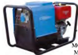
Tutti i nostri prodotti sono di Classe H, IP 23, isolati e testati a temperatura ambiente di 40°C ad una altitudine di 1000 m
