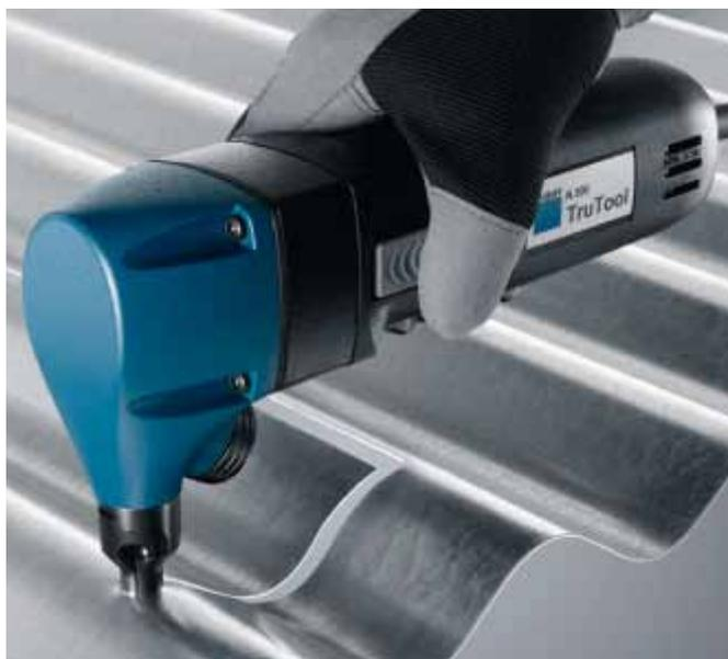
Il punzone tondo brevettato consente di forare acciaio, acciaio inossidabile o metalli non ferrosi fino a 3,5 mm di spessore. Questi strumenti offrono la massima versatilità e raggi di curvatura estremamente ridotti. Sono perfetti per il taglio interno e la dentellatura. È possibile regolare la velocità di rotazione per il taglio lungo linee disegnate o basate su modelli. Inoltre, per la sostituzione dei punzoni non sono necessari strumenti aggiuntivi.
