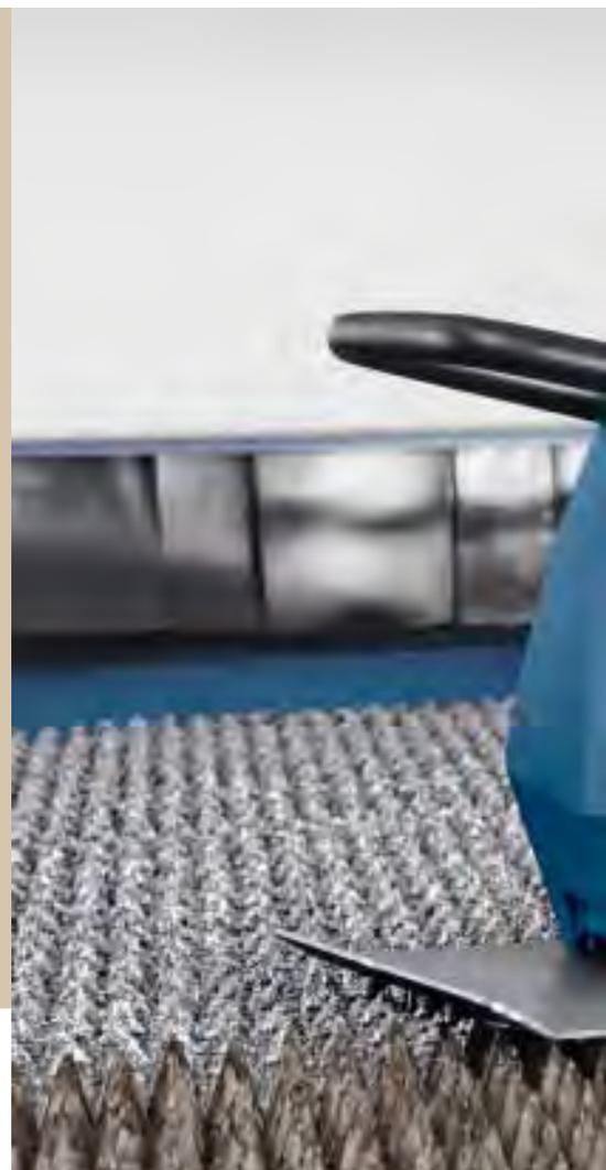
Se per il taglio delle lamiere utilizzate una macchina laser piana, oggi potete risparmiare fino al 75% sul costo delle barre di supporto. La pulitrice TRUMPF TruTool TSC 100 pulisce barre consente di rimuovere le scorie dalle barre, molto più rapidamente rispetto alla pulitura manuale, prolungandone notevolmente la durata.
