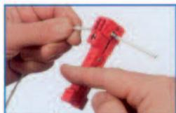
Ruotare l'utensile verso il basso e lontano dall'operatore. Solo due o tre rivoluzioni dell'utensile sono normalmente necessarie per incidere l'isolante.
