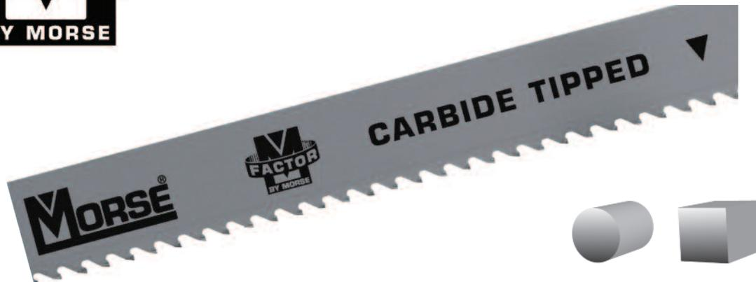
Questa **M-FACTOR™** è una lama con denti in metallo duro per applicazioni più generiche, quali il taglio di metalli ferrosi, come acciai al carbonio e acciai inossidabili e metalli non ferrosi, come rame e bronzo. Ideale per tagliare solidi rettangolari da 50 a 200 mm, barre dai 75 ai 230 mm e tubi a pareti spesse. Da utilizzarsi esclusivamente su macchine automatiche per garantire discese costanti.
