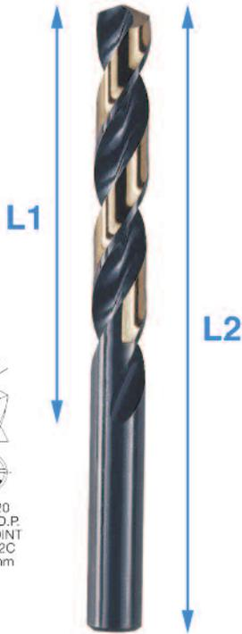
Punte elicoidali altamente PROFESSIONALI, Costruite secondo la norma DIN 338, Codolo cilindrico, fresate e totalmente rettificare. Alta resistenza all'usura, molto più longeve delle tradizionali HSS. Affilatura 130° (SPLIT POINT) per una migliore e più veloce penetrazione nei metalli.
