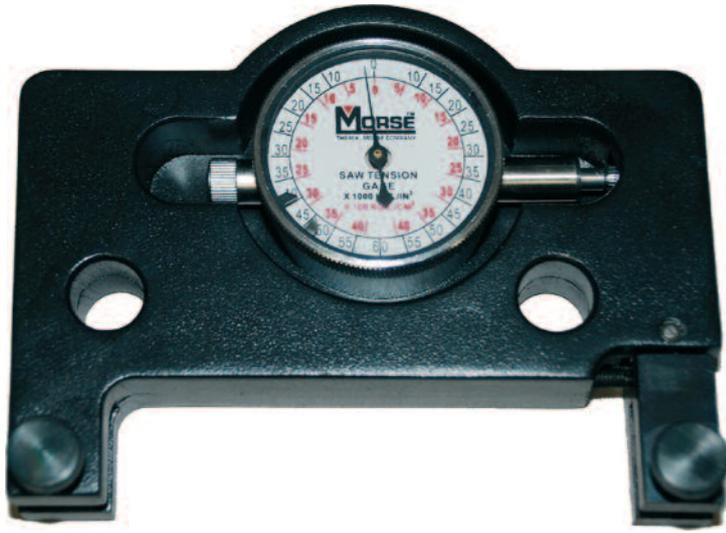
La tensione delle lame per seghe a nastro è uno dei fattori principali che determinano la buona riuscita di un taglio e la giusta usura del nastro.
