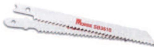
Lame bimetalliche per tagliare anche metalli, acciaio e acciaio inossidabile. Il tagliente dei denti è indurito a 65 Rc e saldato a raggi elettronici su una lama di acciaio flessibile necessaria per una lunga durata.
