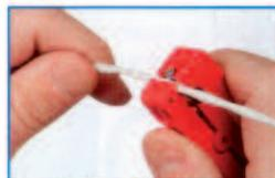
Usare la lama frontale (venduta separatamente). Può essere utilizzata per fare un taglio longitudinale per rimuovere lunghi pezzi di isolante. Inserire il cavo nell'incavo frontale, stringere l'utensile e tirarlo verso l'estremità del cavo.
