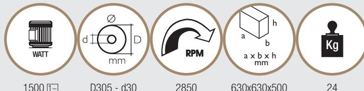
1~ Motore monofase 230 Volt - Hz 50 | Moteur monophasé 230 Volt - Hz 50
