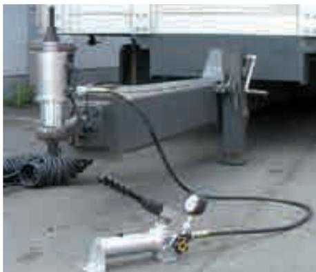
**Cilindro idraulico a stantuffo cavo**
