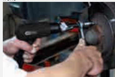
Allentamento delle viti di fissaggio dei dischi freno
