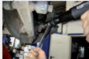
Allentamento delle viti di fissaggio dei dischi freno
