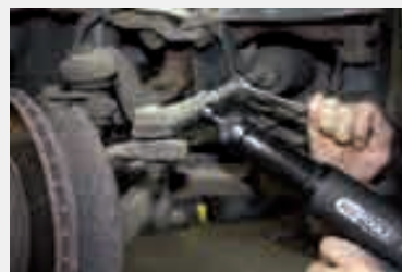
Separazione delle coppie delle ganasce dei freni (ad es. VW T4)
