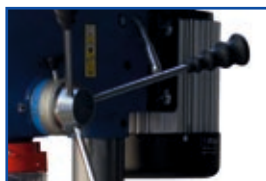
Motore a induzione Moteur à induction
