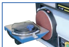
Piano di lavoro con goniometro e disco abrasivo da 150 mm ideale per levigare pezzi curvi o per lavorare le estremità angolari.
