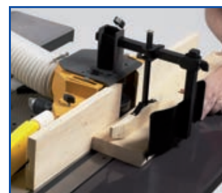
Fresatrice per la lavorazione di contorni e la realizzazione di incastri ed assemblaggi del legno
