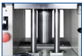
Piano di lavoro per piattatura a spessore montato su 3 guide per evitare basculamenti e rotazioni del piano Table de rabotage en fonte guidée par 3 fûts pour éviter le basculement ou pivotement
