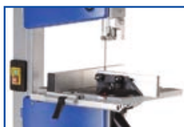
Piano di lavoro in alluminio, inclinabile fino a 45°, goniometro incluso Table de travail en aluminium, inclinable jusqu'à 45°, rapporteur d'angles comprise
