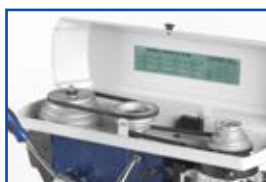
Coperchio superiore con microswitch di sicurezza Capot moteur équipé d'un interrupteur à manque tension
