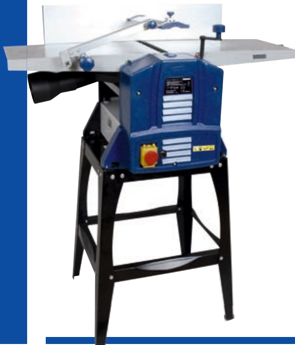
Ampio piano di lavoro (920x262 mm) e guida parallela inclinabile (635x124 mm)
