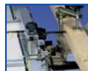
Mortasatrice con carrello mobile Mortaiseuse équipée d'une table mobile
