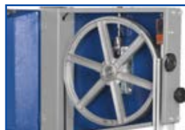
Diametro volani 354 mm ed indicatore di tensione lama Diamètre des volants 354 mm et indicateur de tension de la lame
