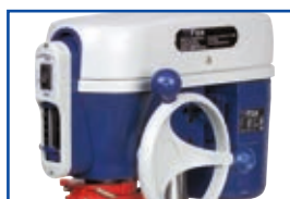
Dispositivo frontale di arresto della profondità di foratura
