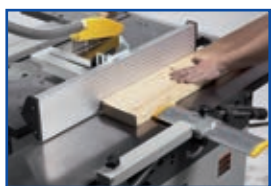
Guida parallela in alluminio per lavori sul piano superiore Guide parallèle en aluminium pour travail sur la table supérieur
