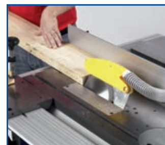
Sega circolare con carrello squadratore e guida laterale
