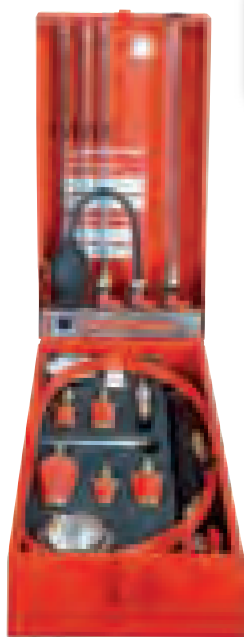
Scala di misurazione da 146,5 mbar fino a 153,5 mbar con punto nullo a 150 mbar su tubicino di prolunga trasparente ad innesto.
