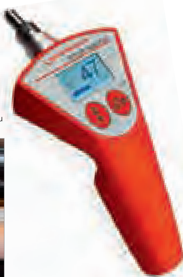
Localizzazione acustica delle perdite su radiatori
