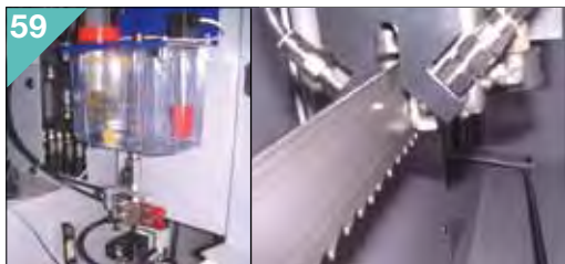
Impianto per lubrificazione minimale. Minimal lubrication system.
