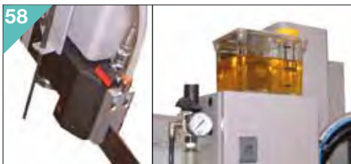
Impianto per lubrificazione minimale. Minimal lubrication system.
