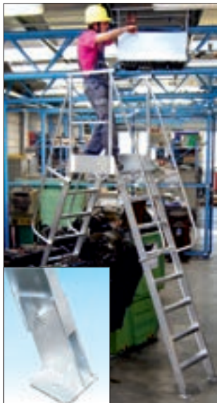
Piattaforma provvista di fermapiedi e parapetto regolamentare di mt.1
