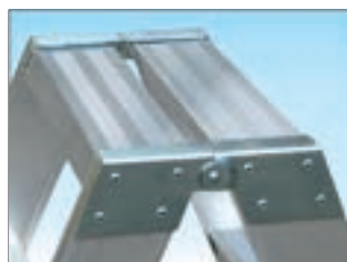
Finitura terminale piatta con cerniera in acciaio crea ripiano mm 180x300
