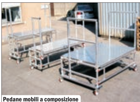
Scala 7780 con piattaforma maggiorata per manutenzione automezzi
