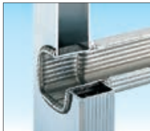
Piolo quadro mm. 30 x 30 anti-scivolo unito al montante verticale con doppia bordatura interna ed esterna
