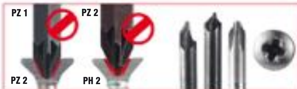
Coppia trasmessa in funzione delle associazioni vite-giravite.
